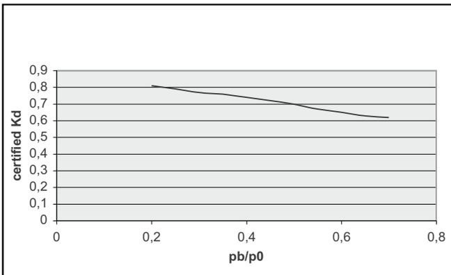
Il diagramma rappresenta la tendenza del coefficiente di efflusso Kd, secondo il rapporto pb/p0 (aeriformi)
